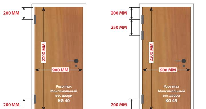
Porta con 2 cerniere e con 3 cerniere. Il peso della porta si intende uniformemente distribuito e l'installazione delle cerniere eseguita a regola d'arte e attenendosi alla scheda tecnica.
